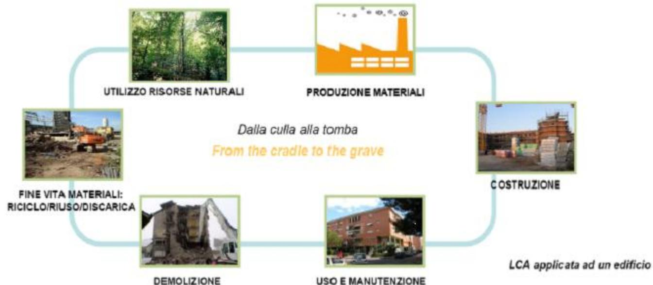
Confine di sistema per lo studio di LCA di un edificio.
