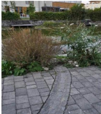
I rain garden sono progettati per drenare l'acqua in 24-36 ore, con overflow nel caso di eventi atmosferici intensi. Quando le superfici di raccolta adiacenti sono impermeabili – come spesso avviene in area urbana.
