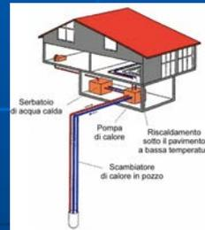
Come è noto ad ogni ingegnere, le pompe di calore sono macchine che spostano il calore in direzione opposta a quella in cui tenderebbe a dirigersi naturalmente, cioè da uno spazio o corpo più freddo verso uno più caldo. In realtà, una pompa di calore non è niente di più di un condizionatore (Rafferty, 1997).
