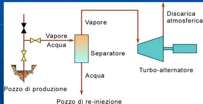
Figura 11: rappresentazione schematica di un impianto a contropressione per generazione di energia elettrica. In rosso il circuito del fluido geotermico.
